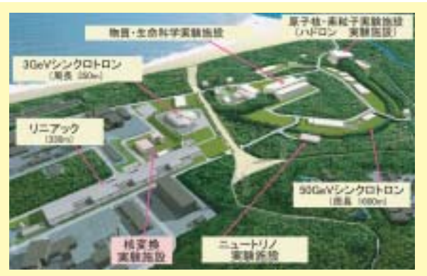
図1 大強度陽子加速器計画 (J-PARC) の概観 1) 。JSNS は、物質・生命科学実験施設内に建設される。 (資料提供：JAEA・KEK J-PARC プロジェクトチーム)
